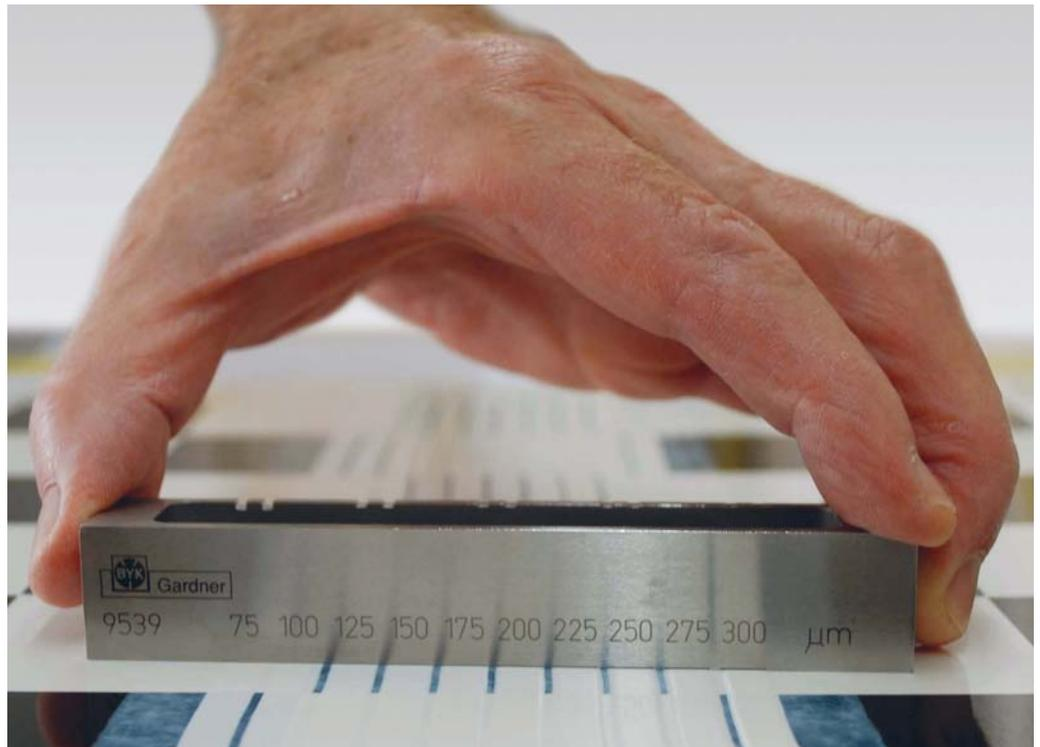
Zur Prüfung des Ablaufverhaltens wird hier das Material mit dem Ablauf-Prüfakel in Schichtdicken von 75 bis 300  $\mu\text{m}$  auf eine Lenetta-Folie mit Schachbrettmuster aufgebracht.
